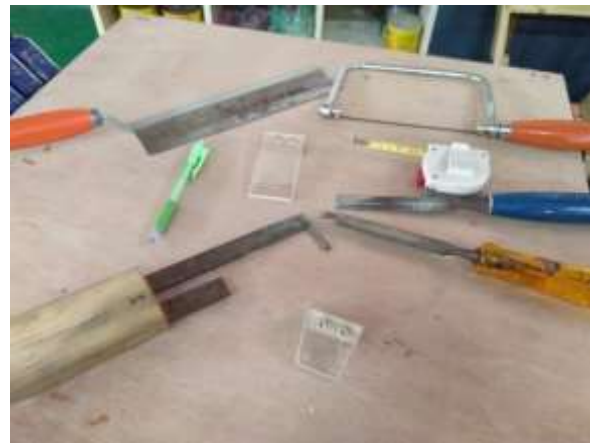
Rajah 3.3 : Alatan tangan ubahsuai bagi menghasilkan tanggam bajang dan bajang litup
