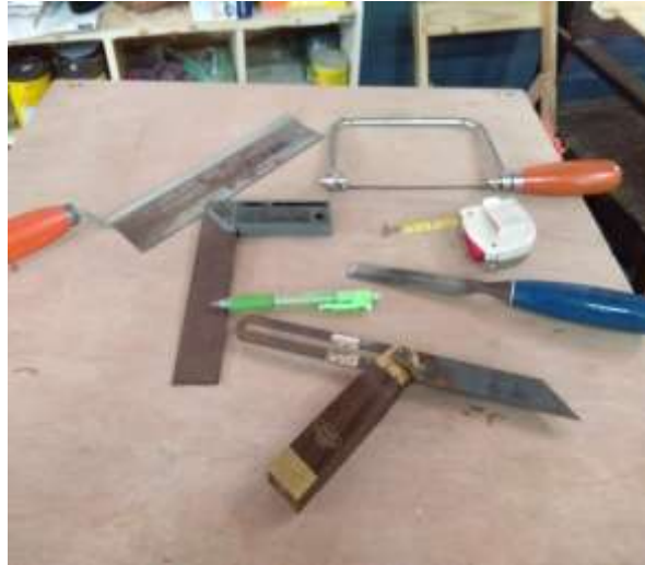
Rajah 3.2 : Alatan tangan asas bagi menghasilkan tanggam bajang dan bajang litup
