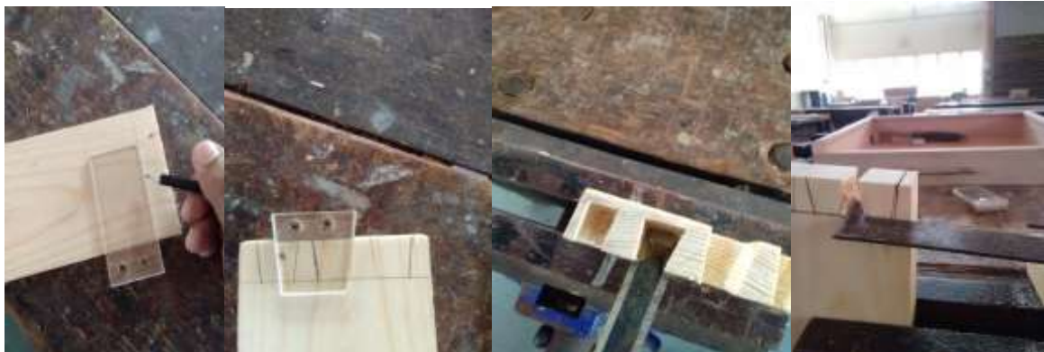
Rajah 3.4 Penggunaan Alat tangan ubahsuai dalam kerja tanggam bajang dan bajang litup.
